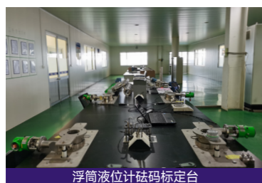
浮筒液位计砣码标定台
